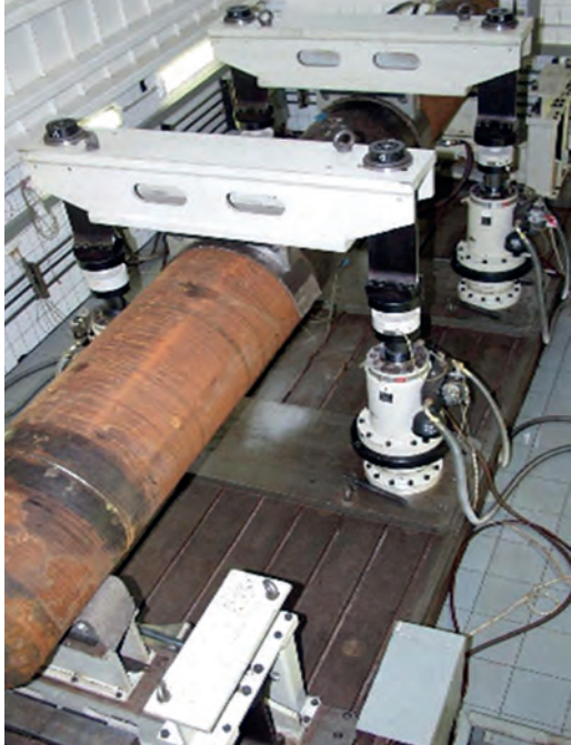
Испытания бывшей в эксплуатации трубы проводятся на гидравлическом стенде «Гидропульс» в ЦТД «Диаскан»
